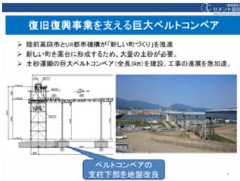
皆様も良くご承知と思いますが、陸前高田市は、沿岸地域の中でも津波による被害が著しく甚大であったところです。市とUR都市機構は、津波被害を想定した住宅の高台移転と低地部のかさ上げによる新たなまちづくり事業を実施しています。津波の浸水を免れるよう高さを確保するために、かさ上げに使用される土砂は、約780万m<sup>3</sup>に上るため、山から採取した土砂を運搬できる全長がおよそ3kmにわたる巨大ベルトコンベアの設置が求められました。ベルトコンベアで運ぶことでトラック運搬では9年かかる工期を2年に短縮することができました。既存の地盤は、この巨大ベルトコンベア設置に耐えられないため、セメント系固化材によって地盤改良されました。コンベヤーは9月に土砂を運び終え、撤去される予定です。
