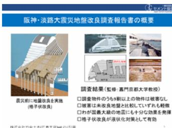
阪神・淡路大震災の改良地盤調査は、京都大学 嘉門教授監修のもと、1995年に実施しました。調査の結果、セメント系固化材を使用した改良地盤が、わが国の都市部を直撃した最大級の地震にも十分な耐震効果を発揮したことがわかりました。また、格子状改良が液状化対策として有効であることが判明しました。
