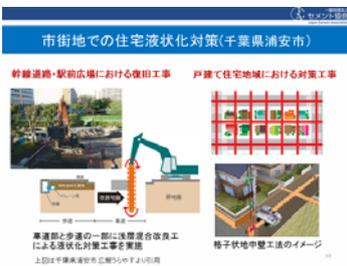
千葉県浦安市は、市面積の86%が液状化の被害を受けました。被害を受けた、公共インフラや戸建て住宅地域の復旧工事は現在も進められています。幹線道路や駅前広場等、公共インフラは、図に示すような攪拌機械で施工しました。戸建て住宅は、図示したように、建物の周囲を格子状の改良体地中壁で造成する工法を用い、2015年度中に試験施工を着工予定です。
