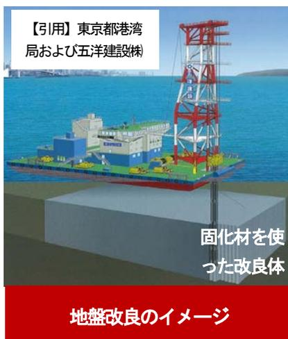
図-4 新海面処分場での固化材の使用例
