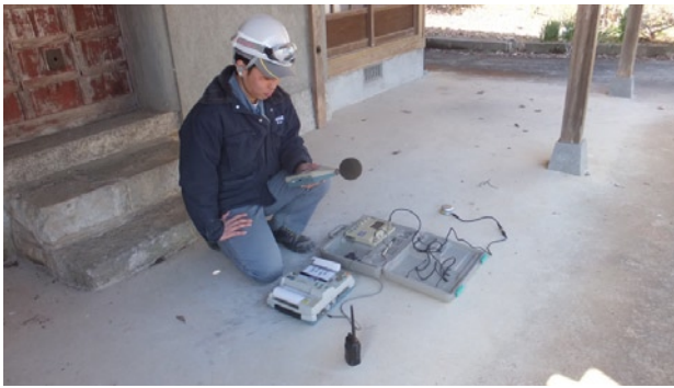
写真4 発破騒音・振動測定風景
