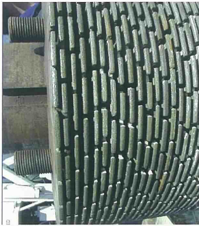
写真5 ダイヤモンドグラインディングに使用する カッターの刃
