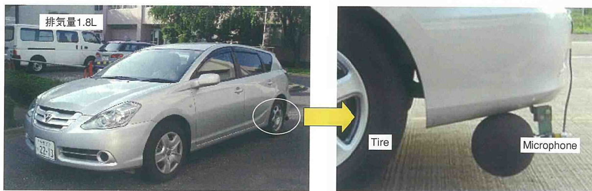
写真6 測定車とマイクロホン設置位置
