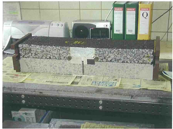
写真14 ベルギーにおけるコンポジット舗装のひび割れ対策の研究
