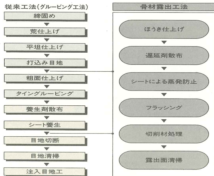
Q21・図1 コンクリート舗装の表面処理工法と施工手順 14)
