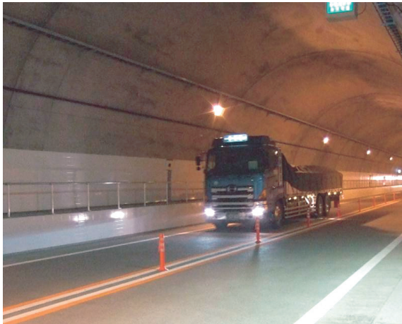
写真-3 道東道での走行抵抗試験状況 (舗装 F, トンネル内コンクリート舗装)
