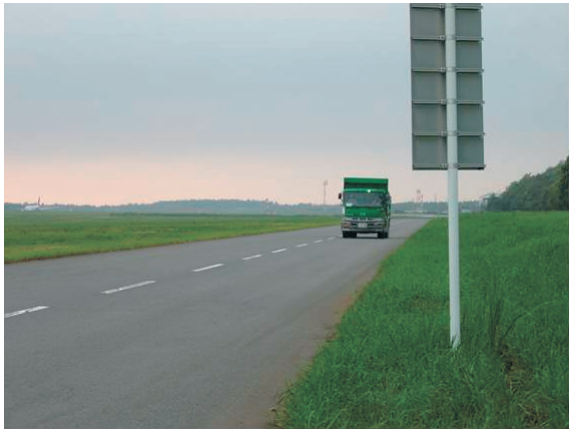
写真-1 成田国際空港での走行抵抗試験状況 (舗装 C, 場周道路アスファルト舗装)
