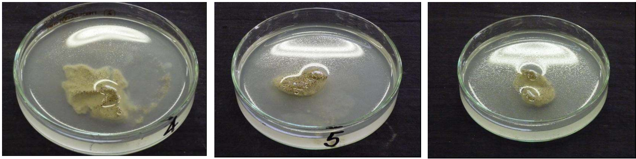
(A) 軽油 1% (油膜 : 少) (B) 軽油 2% (油膜 : 中) (C) 軽油 4% (油膜 : 多) 写真 1 粘土置換率 30%における油膜の発生状況
