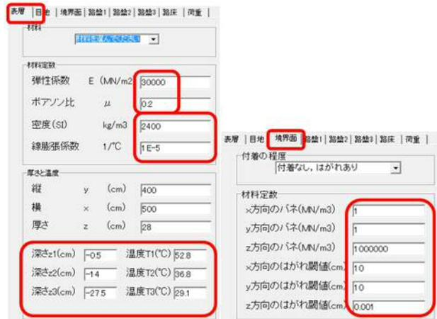
図 6.10 コンクリート版の温度と境界条件の設定
